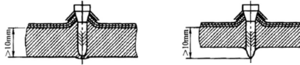
图 6.2.8 射钉的穿透深度
